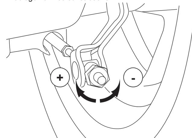
Pritisnuti ručicu kočnice i provjeriti položaj oznake istrošenosti spona brijega (B) u odnosu na oznaku (C) kućišta motora.
