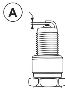
A. Razmak elektroda: 0.6 do 0.7 mm.
