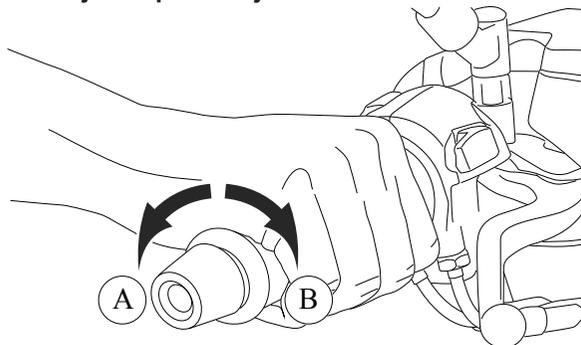
Za povećanje brzine, okretati ručicu gasa u smjeru (A). Za smanjivanje brzine, okretati ručicu gasa u smjeru (B).
