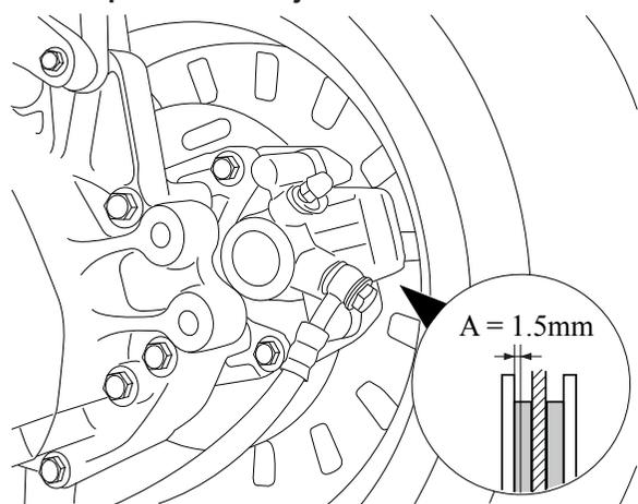
Ako je jedna od 2 pločice istrošena do minimalne kote (A), potrebno je zamijeniti 2 pločice kočnice.
